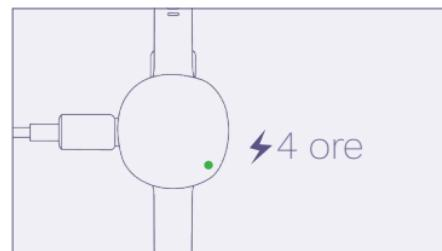
Carica il braccialetto Ava per almeno quattro ore prima del primo utilizzo e poi due ore ogni giorno, fino a quando il LED mostra una luce verde fissa.
